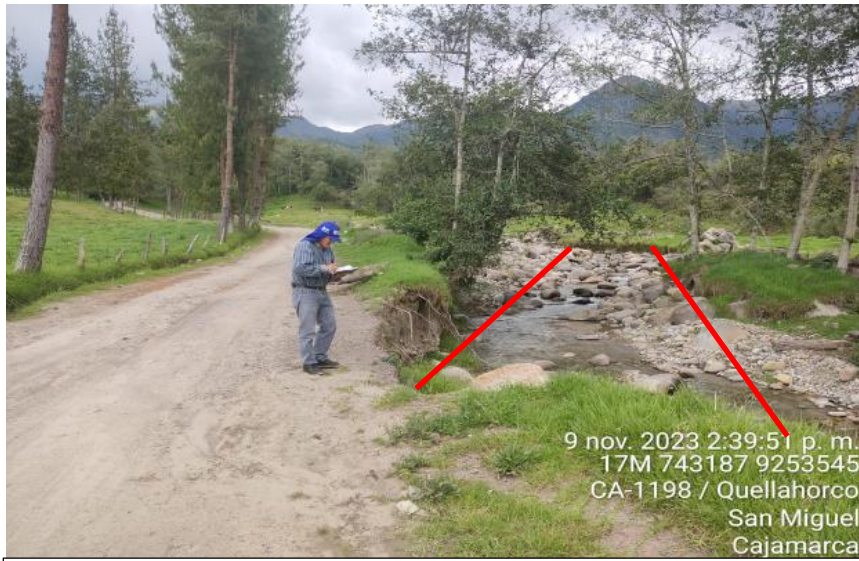
IMAGEN N° 01: VISTA DE TRAMO CON AMBOS MARGENES VULNERABLES DEL RIO COLPA EXPUESTOS ANTE CRECIDA DE CAUDAL DE LA QUEBRADA
